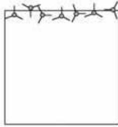
Si vous êtes incapable de toucher de façon régulière le bord supérieur de la cible, il y a probablement un petit défaut de réglage. Pour le résoudre, essayez de changer le point d'encochage (le déplacer d'à peine 1 mm à la fois vers le haut ou vers le bas) et tirer de nouveau.
